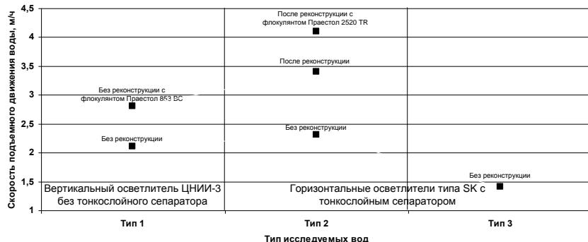
Рис. 7 Влияние типа воды, режимных и конструктивных факторов на максимальную допустимую скорость подъёмного движения воды в горизонтальных и вертикальных осветителях.
