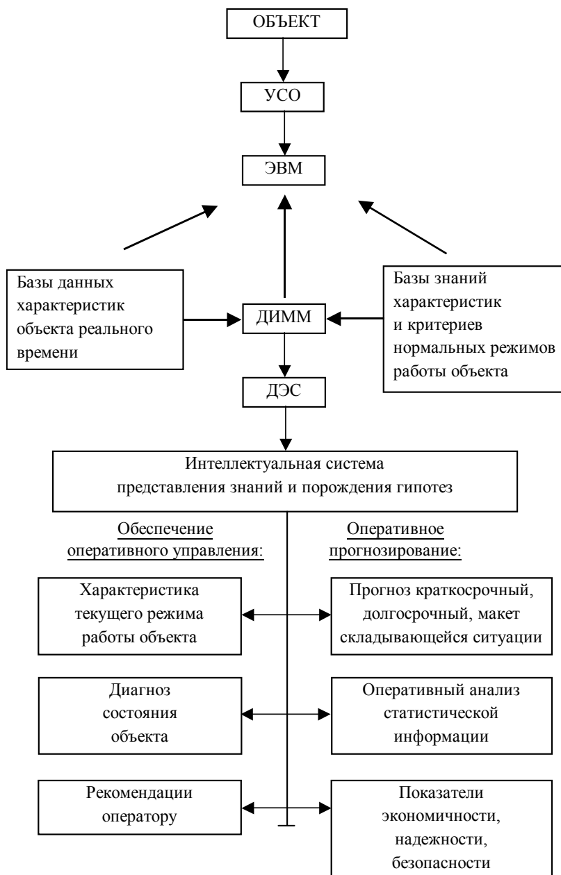
Рис. 2. Общие принципы построения ДЭС оценивания СДС, функционирующей в реальном времени
