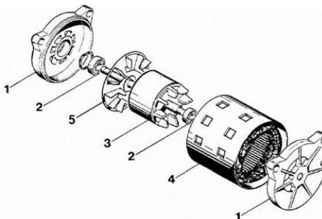
Рис. 1. Устройство асинхронного двигателя
