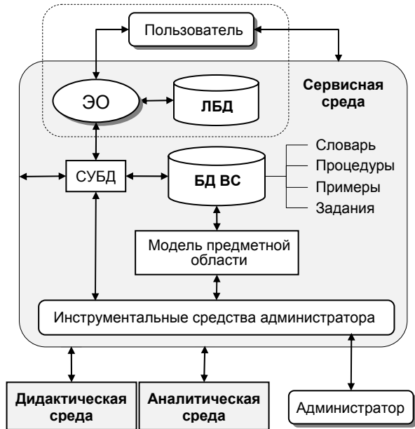
Рис. 4. Схема взаимодействия основных компонентов сервисной подсистемы
