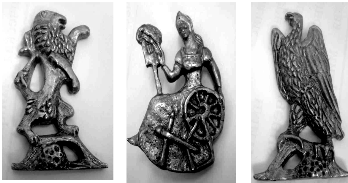
Рис. 2. Латунные патинированные отливки с фактурной и полированной поверхностью
