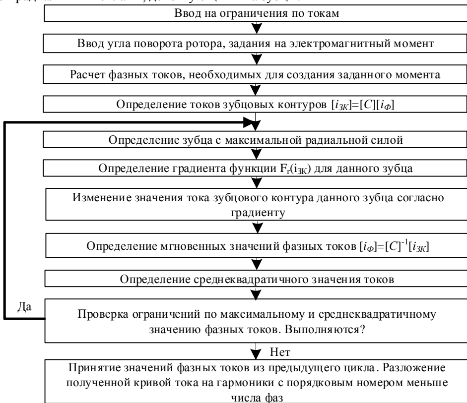
Рис. 3. Алгоритм формирования формы фазных токов, обеспечивающих улучшение вибросиловых характеристик многофазного СДПМ.
