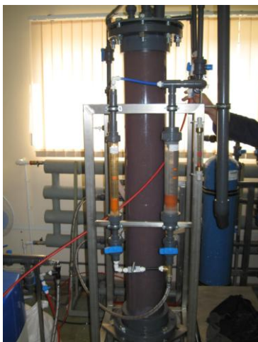
Рис. 2. Внешний вид лабораторной установки ионитного фильтра
