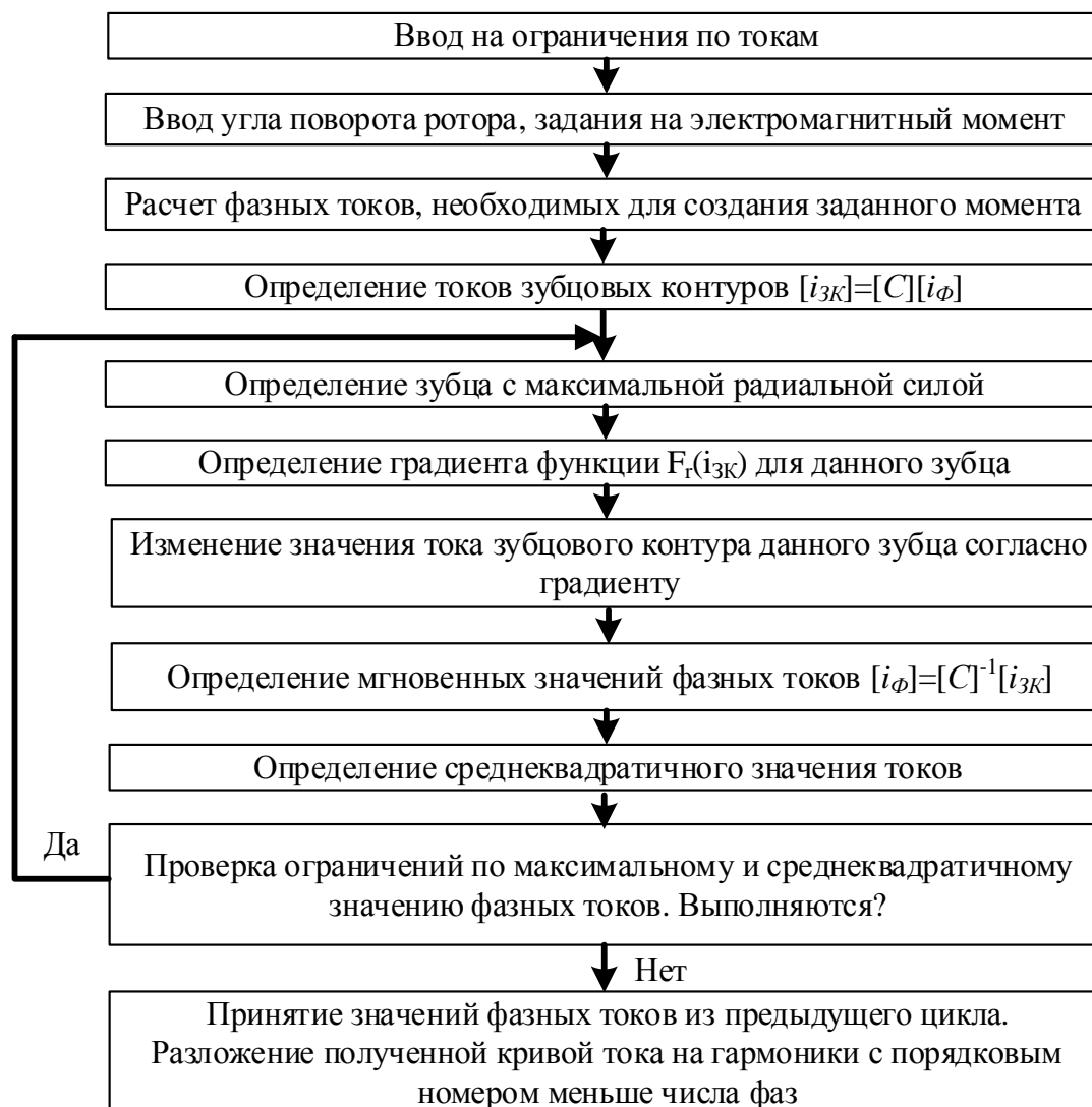
Рис. 2.24. Алгоритм формирования формы фазных токов, обеспечивающих улучшение вибросиловых характеристик многофазного СДПМ.
