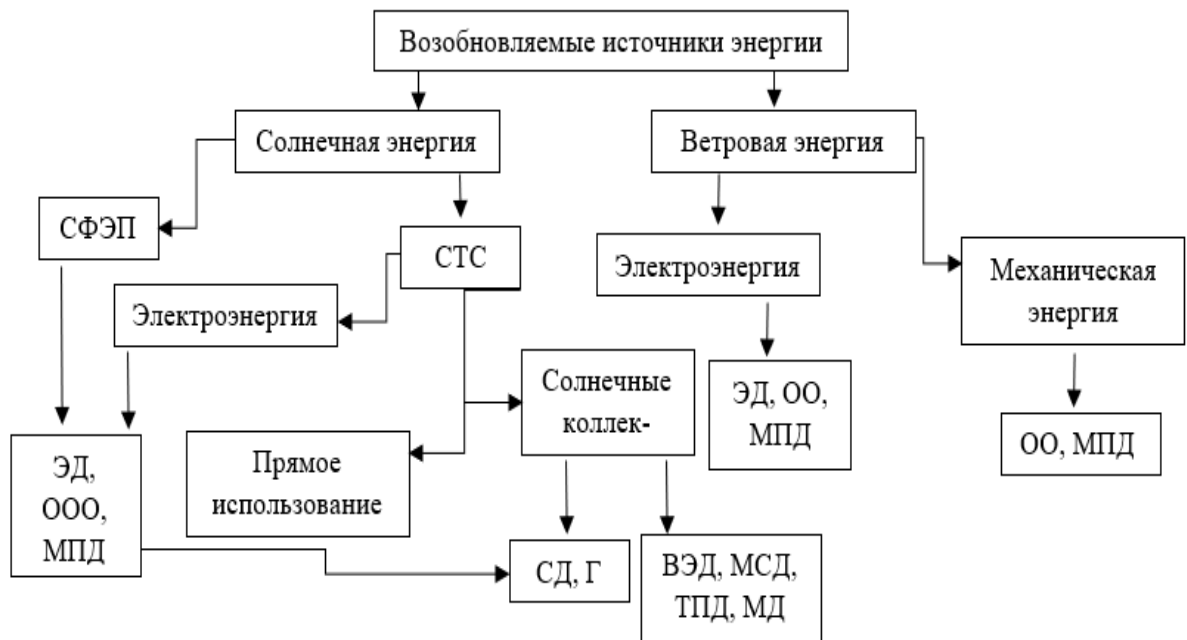
Рисунок 2.1. Возможные технологические комбинации основных ВИЭ и методов опреснения воды
