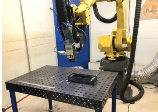
Рисунок 71 - Размещение корпуса магнитного устройства на столе
