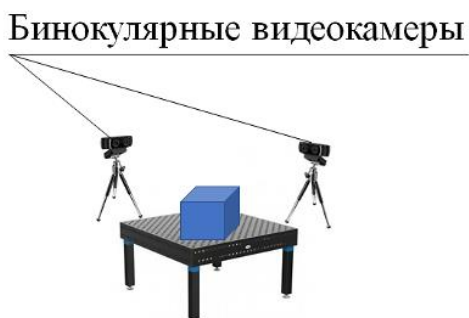
Рисунок 3 - Схема детектирования свариваемой детали на столе с помощью двух бинокулярных видеокамер размещенных на штативе
