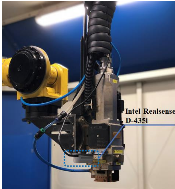
Рисунок 64 - Размещение датчика глубины Intel Realsense D-435i на лазерной головке
