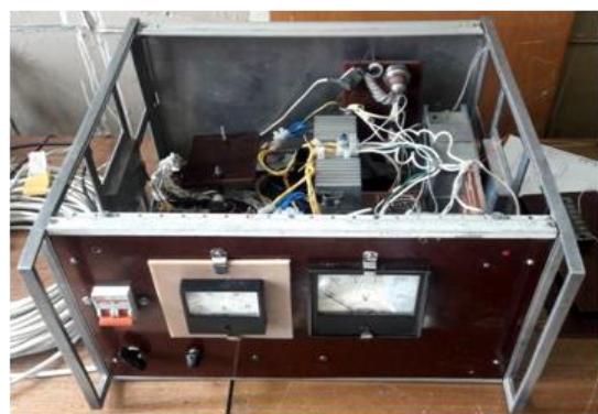
Рис. 4.6. Внешний вид транзисторных преобразователей напряжения мощностью 4 кВт (а) и 7 кВт (б)
