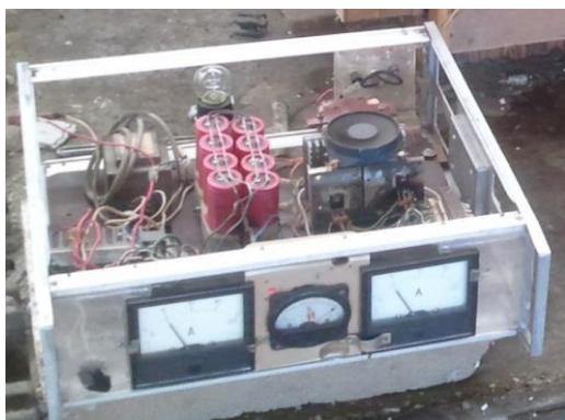
Рис. 4.6. Внешний вид транзисторных преобразователей напряжения мощностью 4 кВт (а) и 7 кВт (б)
