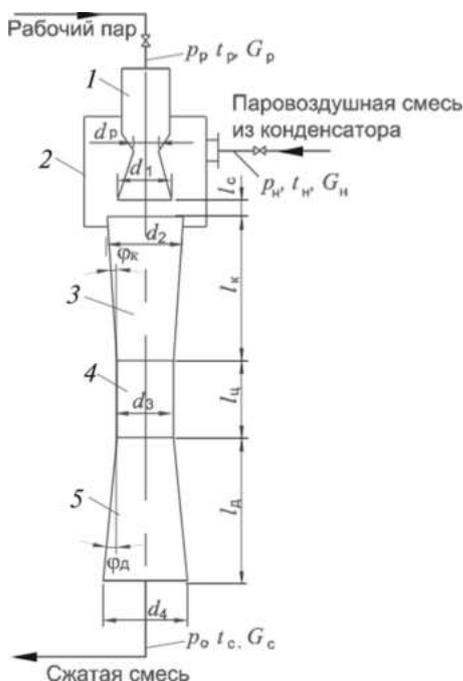
Рисунок 1.5.2 - Принципиальная схема пароструйного эжектора: 1 – рабочее сопло; 2 - приемная камера; 3 - коническая часть камеры смешения; 4 – цилиндрический участок камеры смешения; 5 – диффузор
