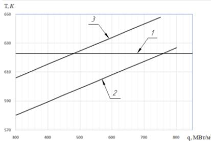
Рис. 1. Зависимость скорости наступления ограничений максимальной температуры оболочки твэла от удельной мощности тепловыделений: 1- максимальная температура оболочки; 2- при постоянных свойствах; 3 - при переменных свойствах.
