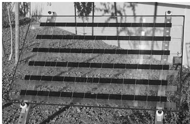
Рис. 2. Первый прототип коммерческой голографической солнечной батареи
