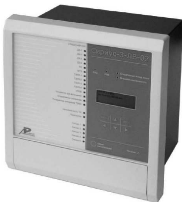
Рис. 3. Внешний вид лицевой панели «Сириус-3-ЛВ»
