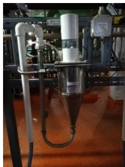
Рисунок 1. Схема включения рН-метра для измерения значений pH_{25} известкованной воды и его фотография: 1 – пробоотборная линия (вход); 2 – подача промывочной воды; 3 – регулятор расхода пробы на гидроциклон; 4 – гидроциклон; 5 – выход использованной пробы; 6 – отвод пробы из пробоотборника
