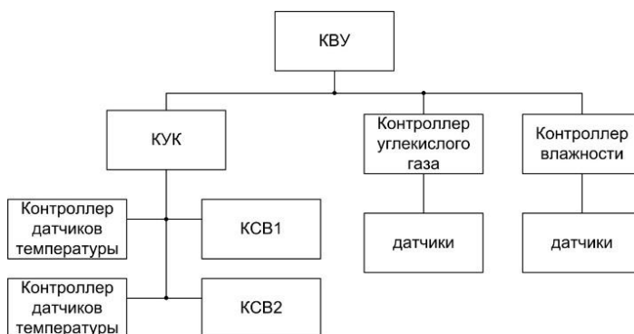
Рисунок 1 – Структура системы управления отоплением в теплице
