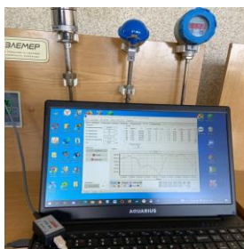
Рисунок 1 – Подключение ТПУ 0304/М2-Н к персональному компьютеру
