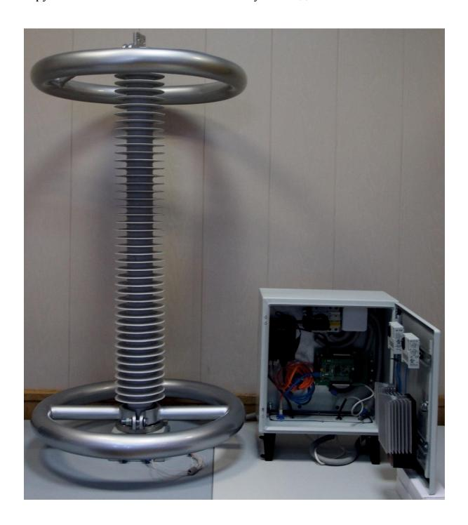
Рисунок 1 – Экспериментальный образец ЦТН с одним первичным преобразователем
