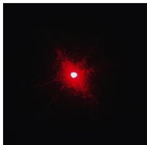
Рис. 2. Картина, полученная при прохождении луча малой мощности через слой магнитной жидкости
