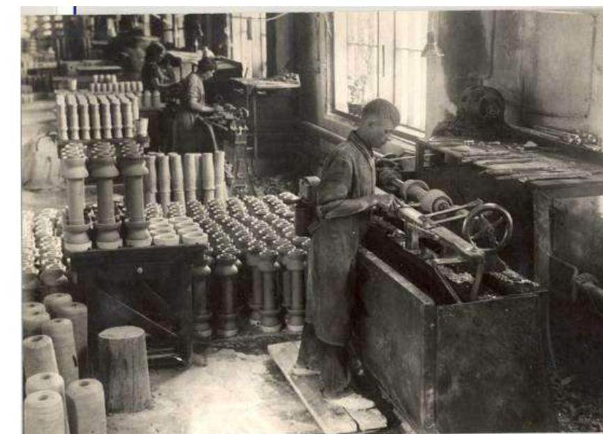
1950-е. Производство проходных изоляторов.
