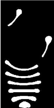
Рис. 4. Форма капель воды в магнитном поле в закритическом поперечном магнитном поле
