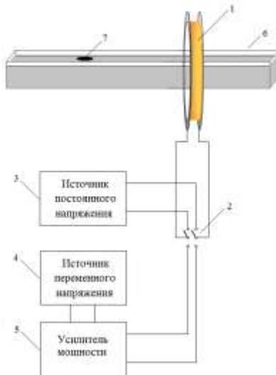
Рис. 1. Схема экспериментальной установки по изучению особенностей движения капли магнитной жидкости в неоднородном магнитном поле
