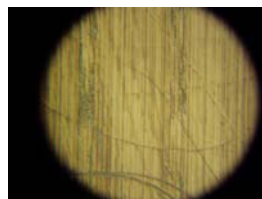
Рис. 2. Исходная поверхность детали с гальванопокрытием, алмазным выглаживанием и импульсной магнитной обработкой (ув.х2400)
