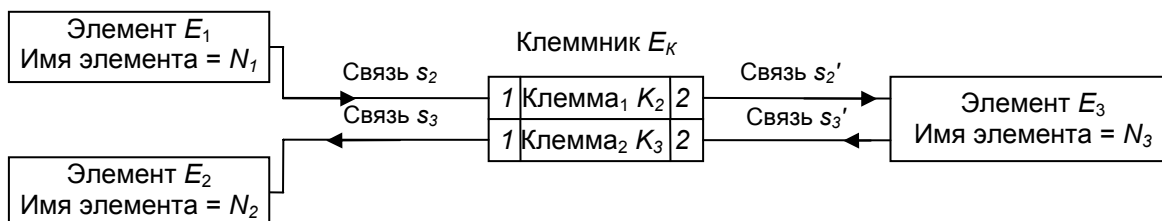
Рис. 10. Инверсия связей на контактах клеммы (стрелками показано направление связей)
