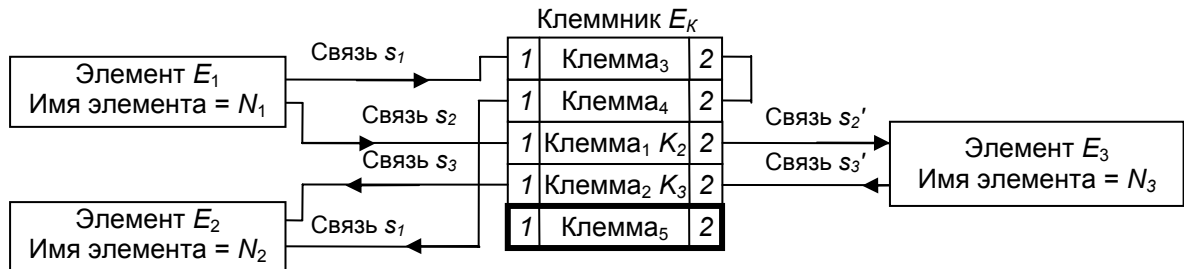
Рис. 13. Добавление резервной клеммы
