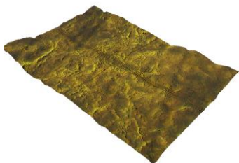
б) Шероховатость R_a=0,258\text{ мкм} , СОТС с составом №1. Увеличение \times 40
