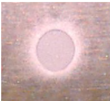
Рис. 1. Фотография полученного отверстия при электрохимической обработке никеля
