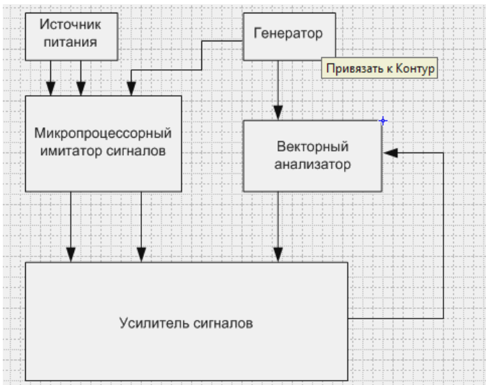
Рис. 1. Функциональная схема для проверки усилителя сигналов
