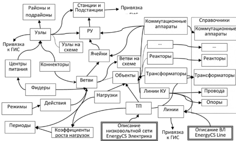
Рис. Схема связей между сущностями в БД EnergyCS Эта схема реализована в БД программного комплекса EnergyCS
