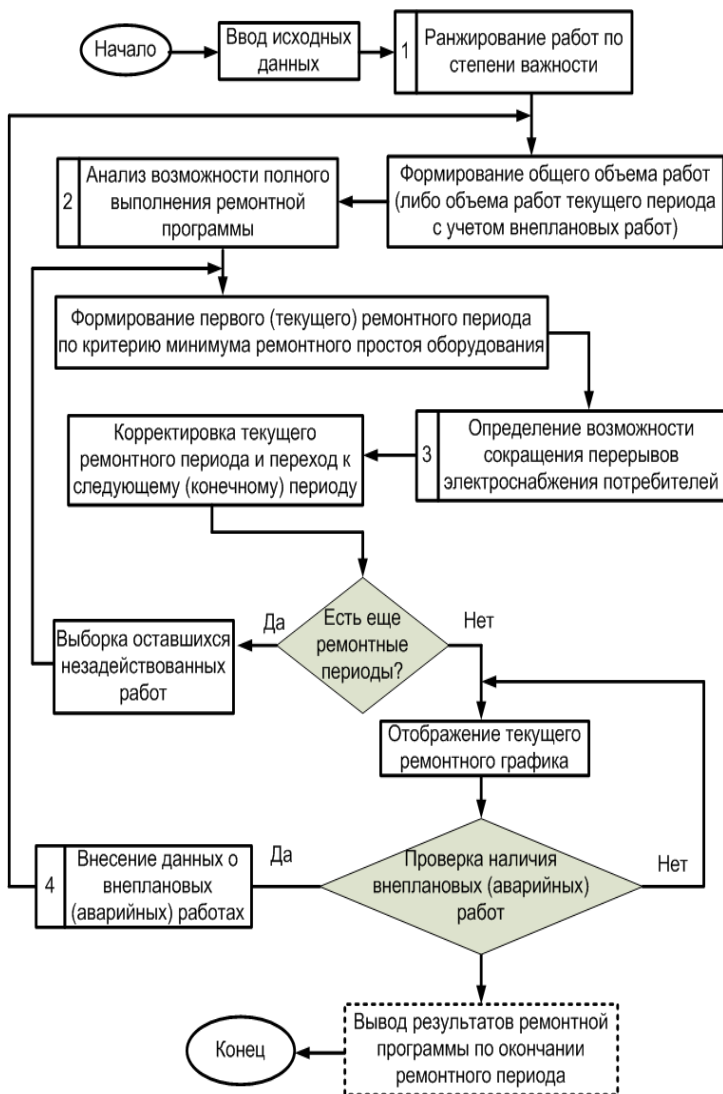
Рису. 1. Упрощенная структура алгоритма оптимизации планирования ремонтов с указанием этапов участия экспертов
