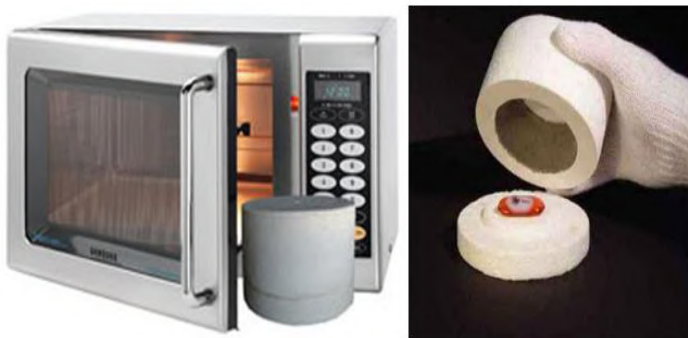
Рис. 3. СВЧ установка косвенного действия для изготовления стеклянной бижутерии по фьюзинг-технологии
