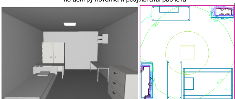
Рис. 4. Общий вид жилой комнаты при расположении светильника в центре потолка и результаты расчета
