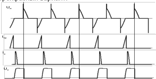
Рис. 2. Временные диаграммы напряжения на нагрузке ( U_n ), тока в первичной обмотке трансформатора ( I_{1p} ), тока заряда конденсатора ( I_c ) и напряжения на конденсаторе ( U_c ).
