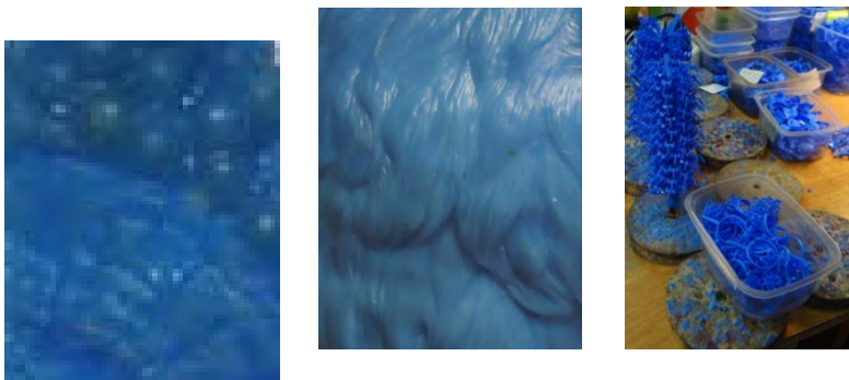
Рис. 1. Пример этапа изготовления литых изделий: а – поверхность восковой мастер-модели, требующая доработки; б – фрагмент поверхности изделия готового к отливке; в – подготовка партии восковок (елочка) для отливки
