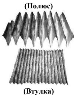
Рис. 4. Модель рабочего зазора, составленного из поверхностей втулки (сталь 40X13) с шероховатостью Ra=0,945 мкм ( Rz = 4,026 мкм) и полюса (сталь 3) с шероховатостью Ra=3,301 мкм ( Rz = 14,333 мкм)
