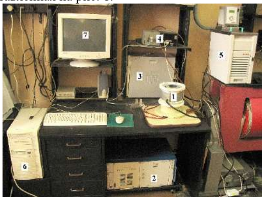
Рис. 1. Установка для локальной магнитной гипертермии (1 – индуктор низкочастотного магнитного поля; 2 – усилитель мощности; 3 – согласующий трансформатор; 4 – блок регистрации и контроля температуры с датчиками температуры; 5 – термостат; 6 – персональный компьютер; 7 – монитор)
